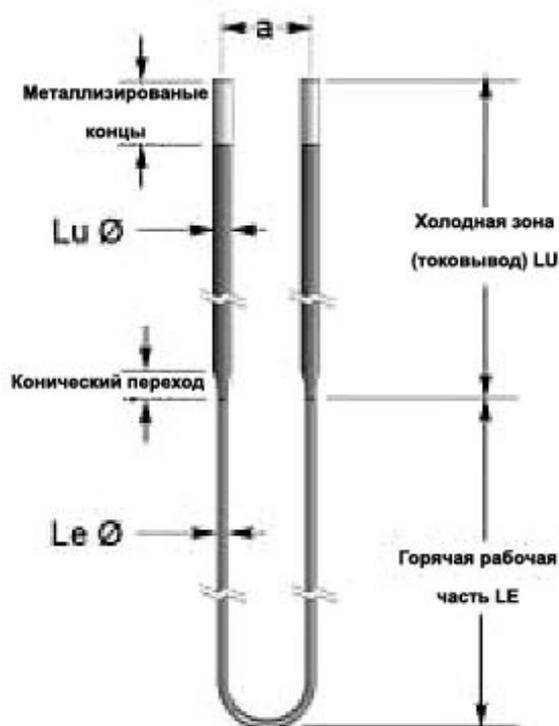
Эти элементы являются элементами U-типа и чаще всего используются подвешенными рабочей частью вниз. Элемент состоит из двух токовыводов (Lu) и рабочей зоны в виде буквы U (Le). Токовыводы имеют диаметр в два раза больше диаметра рабочей зоны, эти две зоны скреплены между собой сваркой. Кончики металлизированы алюминием для обеспечения низкого сопротивления контактной поверхности, к которой электрические контакты прикреплены при помощи плоских плетеных алюминиевых ремешков.
